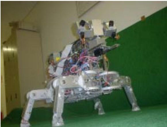
Fig. 4 四足歩行ロボットの外観
